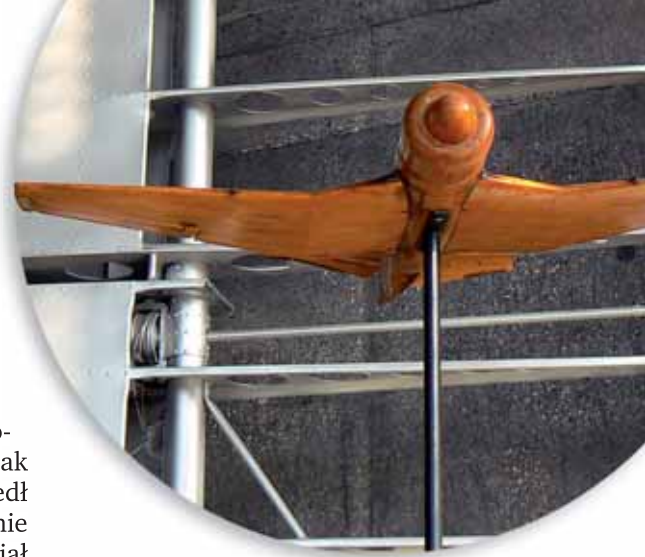
Drewniany model samolotu przeznaczony do badań w tunelu aerodynamicznym
